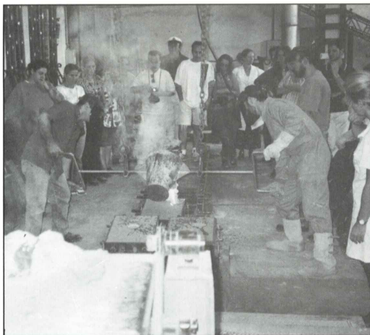
Momento de llenado de las cajas con bronce fundido.
